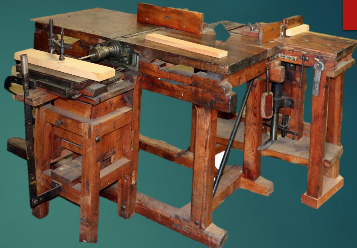
Scie à ruban et combiné 3 opérations Fabrication artisanale par Henri Grill – Saint-Crépin Bâtis, table et roues en bois, Moteur électrique, 1957
