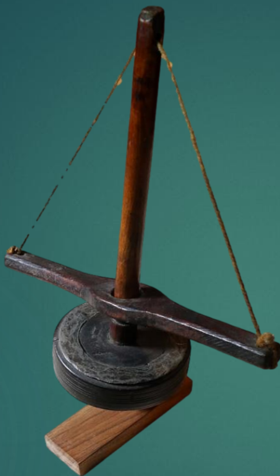
Drille à pompe du XVIII e Volant lesté de plomb
