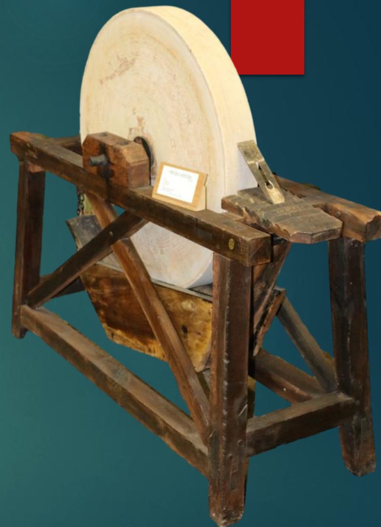
Meule à affuter, grès et chêne Transmission par poulie
