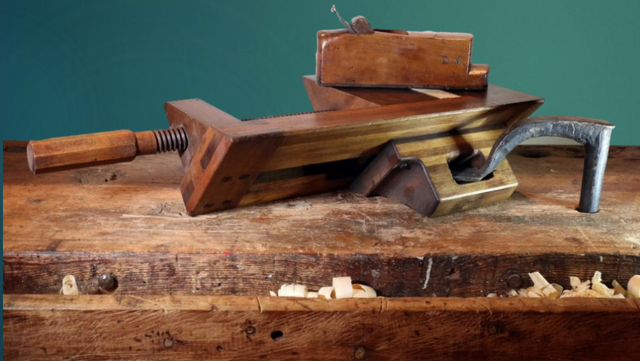
Boîte à recaler XIX e Retouche des onglets Assemblage à 45°
